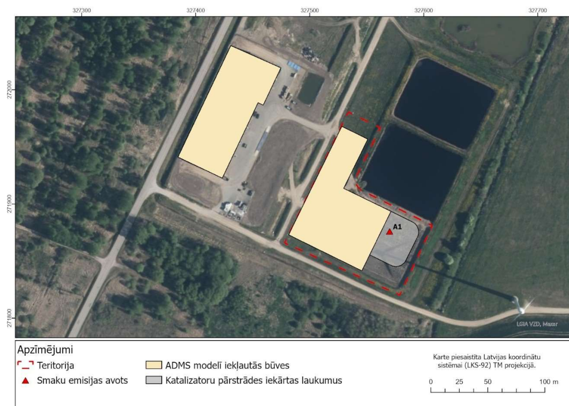
3.32. attēls. Smaku emisijas avotu izvietojums, pamatprocess – apdedzināšana rotācijas krāsnī (avots: SIA "Estonian, Latvian & Lithuanian Environment", "Ietekmes uz vidi novērtējuma ziņojums SIA "VNiMo Services" izlietoto katalizatoru apstrādes būvniecība Grobiņas pagastā, Dienvidkuzremes novadā")
