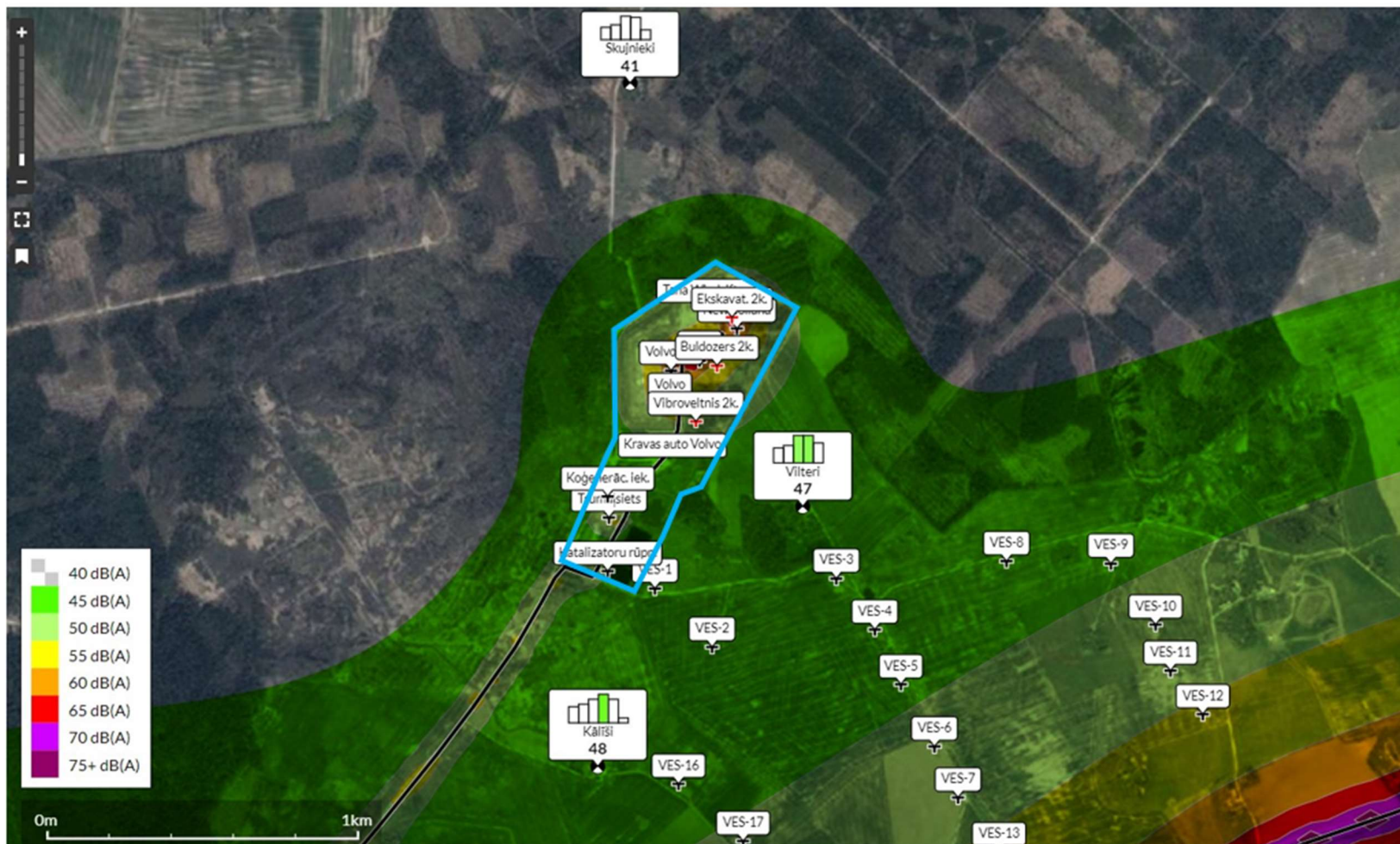
3.34. attēls. Aprēķinātais kopējais (fona līmenis un uzņēmuma ietekme) trokšņa līmenis paredzētās darbības teritorijas apkārtnē trokšņa rādītājam L_{diena} ; norādīts trokšņa līmenis pie konkrētām dzīvojamām mājām
