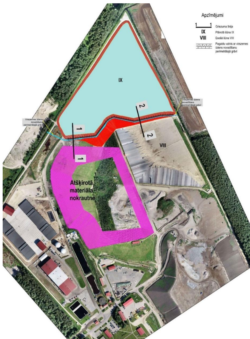
3.34. attēls. Būvniecības darbu 1. kārtā: rekultivācijas pārklājošā slāņa izņemšana, atkritumu izņemšana un inertās kārtas ievietošana, 1-1 griezumā un 2-2 griezumā izvietojums
