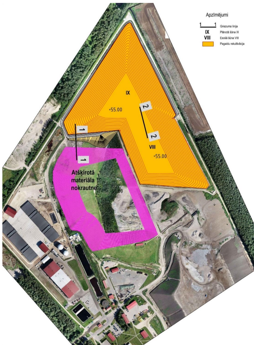
3.51. attēls. Būvniecības darbu 4. kārtā: šūnas Nr. VIII un šūnas Nr. IX pagaidu rekultivācija
