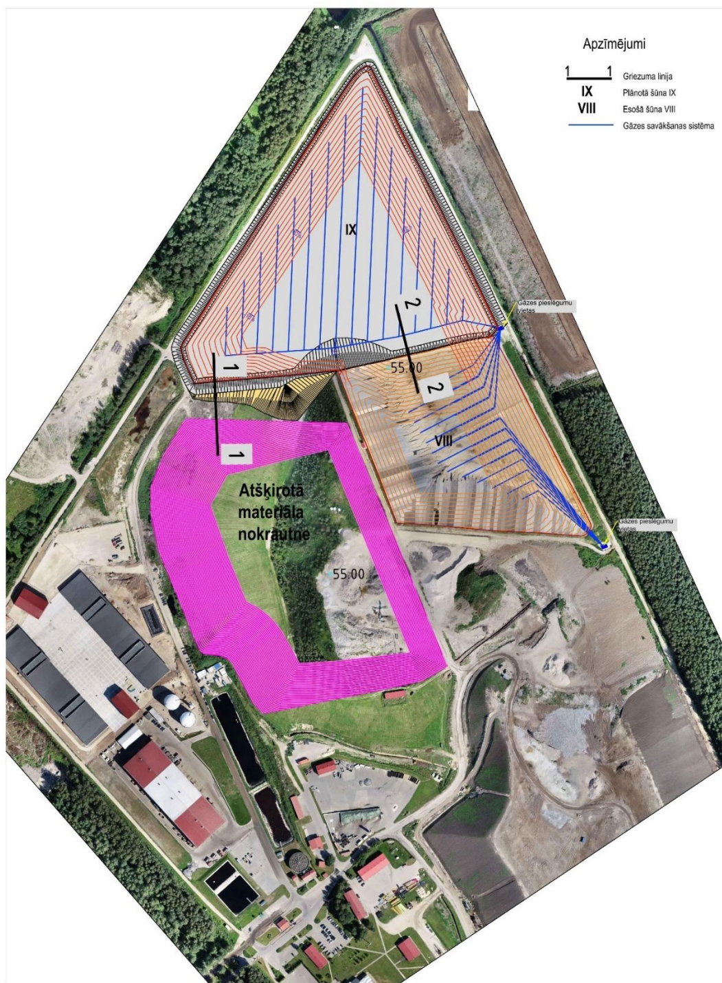
3.43. attēls. Būvniecības darbu 3. kārta: Atkritumu aizpildīšana un gāzes savākšanas sistēmas izbūve šūnā Nr. IX un šūnā Nr. VIII
